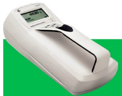
Kondensacinis aerozolio dalelių skaitiklis– CPC (Modelis 3007); 0,01 – >1 \mu\text{m} (bendra koncentracija)
